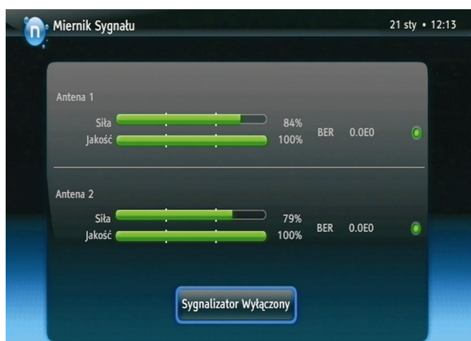
nRecorder Turbo we współpracy z Multi Band Converterem. Także tutaj widać niewielką różnicę poziomów siły sygnału, ale i ona nie ma żadnego znaczenia. Jakość 100 % gwarantuje prawidłowy odbiór.
