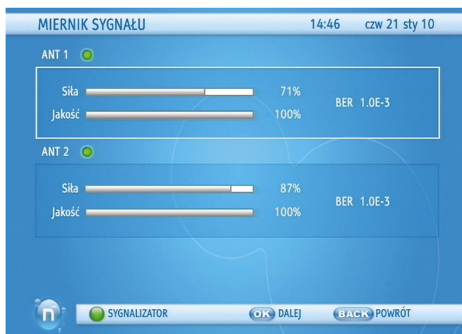
Wszystko wskazuje na to, że testowany, starszy model nRecordera ma tory sygnałowe różniące się charakterystyką i czułością. Widać to już przy podłączeniu bezpośrednio do multiswitcha.
